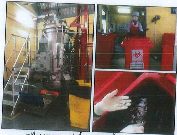
รูปที่ ๘ กระบวนการฆ่าเชื้อของขยะติดเชื้อทางการแพทย์
