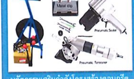
นวัตกรรมเสริมกำลังโครงสร้างคอนกรีตด้วยแผ่นเหล็กอัดแรงรัดรอบภายหลัง
