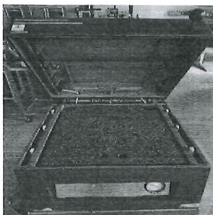
ภาพที่ 4 ชุดฝาของเครื่องซีล
