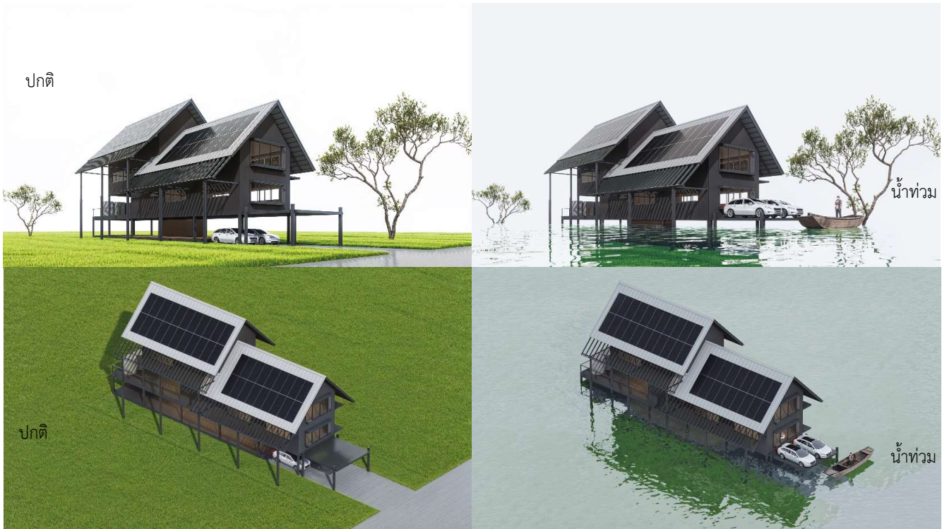
ภาพ 7 บ้านอยู่ร่วมน้ำท่วมแบบไม่มีทางลาด ติดตั้งลิฟท์ยกรถยนต์แทนทางลาด และใช้เป็นหลังคาโรงรถในช่วงเวลาน้ำไม่ท่วม แต่ผู้ใช้ต้องทำการเดินขึ้นบันไดจากชั้นใต้ถุนเพื่อเข้าบ้านในทุกวัน
